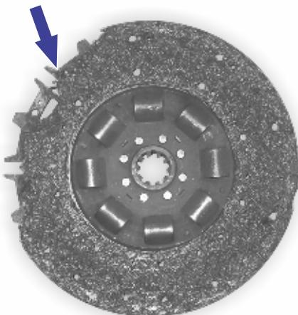
**ПРОБЛЕМ:** Кваčilo proklizava. **ДЕФЕКТ:** Пробуксовка сцепления.
