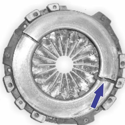
**ПРОБЛЕМ:** Кваčilo proklizava. **ДЕФЕКТ:** Пробуксовка сцепления.
